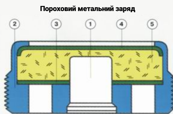
1 - капсюль-запальник; 2 - гільза; 3 - кільце; 4 - кришка; 5 - пороховий заряд.
